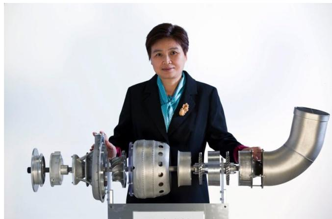
世界上第一台使用 3D 打印的全尺寸喷气发动机
